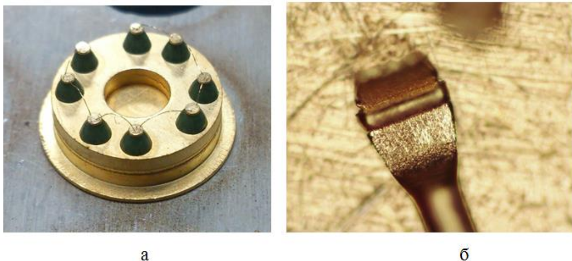
Рисунок 2 – Тестовый образец с контактами "золото-золото" (а) и фрагмент контакта (б)
